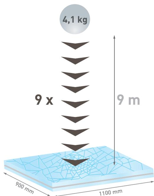
Ce vitrage retardateur à l'effraction résiste à la perforation d'une bille de 4,1 kg, lâchée 9 fois d'affilée de 9 m de haut. En cas de bris de vitrage, les films P.V.B. retiennent les fragments de verre en place. Dans l'attente de son remplacement, le vitrage présente l'avantage de rester stable.
