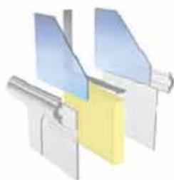
Cette catégorie de panneaux est la plus luxueuse. Outre les cadres en aluminium spéciaux, les panneaux ont des motifs fraisés ce qui impose l'utilisation d'une tôle d'aluminium plus épaisse qui donne au panneau une plus grande rigidité et résistance à l'effraction.
